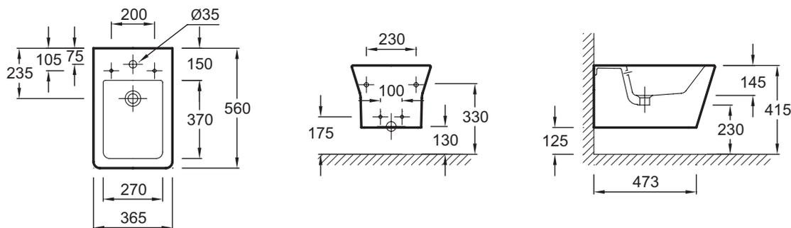
Descriptif CCTP : Bidet suspendu caréné. E4812. Collection : RÊVE. DIMENSIONS : 56 x 36,50 cm. POIDS : 19 kg. MATÉRIAU : Céramique. TYPE D'INSTALLATION : Suspendu. HAUTEUR : Réglable de 38 à 50 cm. TYPE D'ABATTANT : A descente progressive. PRODUIT INCLUS : Couvercle et fixations. ABATTANT : 1. FIXATION DE LA CUVETTE : Cachées.
