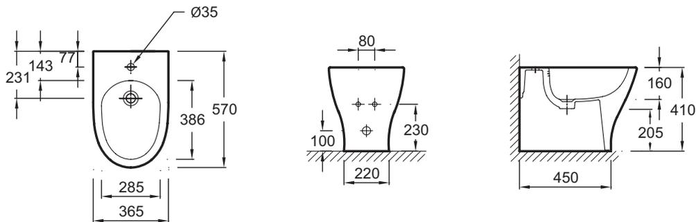
Descriptif CCTP : Bidet au sol. E4798. Collection : ODÉON UP. DIMENSIONS : 57 x 36,50 cm. POIDS : 19,8 kg. MATÉRIAU : Céramique. TYPE D'INSTALLATION : Au sol. NORMES ET RÉGLEMENTATIONS : NF. HAUTEUR : Confort. BRIDE : 1. PRODUIT INCLUS : (robinetterie non incluse). MÉCANISME SILENCIEUX : Silencieux classe 1. ISOLATION PHONIQUE ET THERMIQUE DU RESERVOIR : Non. GARANTIE DE LA CÉRAMIQUE : 10 ans. CONDITIONNEMENT : 1 colis. Percé 1 trou de robinetterie.
