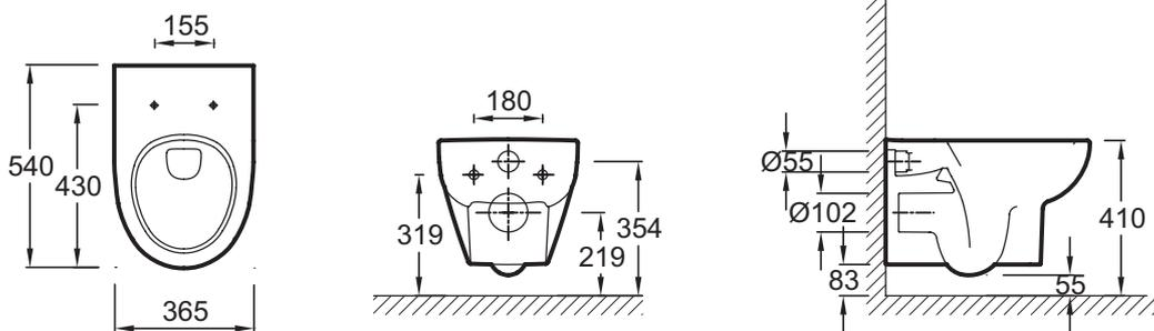
Descriptif CCTP : Cuvette suspendue. E4764. Collection : ODÉON UP. DIMENSIONS : 54 x 36,50 cm. POIDS : 25,8 kg. MATÉRIAU : Céramique. TYPE D'INSTALLATION : Suspendu. NORMES ET RÉGLEMENTATIONS : NF. CONSOMMATION D'EAU : 2,6/4 L et 3/6 L. BRIDE : 1. PRODUIT INCLUS : (abattant, bâti-support et plaque de commande non inclus). GARANTIE DE LA CÉRAMIQUE : 10 ans. CONDITIONNEMENT : 1 colis.
