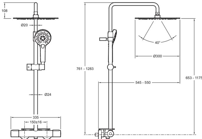
Descriptif CCTP : Colonne de douche. E26589. Collection : METRO. TYPE D'INSTALLATION : Mural. ECO CONSO : eco d'eau. AVEC OU SANS ROBINETTERIE : AVEC ROBINETTERIE. TYPOLOGIE DE ROBINETTERIE DE DOUCHE : Thermostatique. INVERSEUR : Intégré. BUTÉE DE SÉCURITÉ : 37°C. TEMPÉRATURE MAXI : 50°C. CLAPET ANTI-RETOUR : Oui. DÉBIT DOUCHETTE : 10 l/mn. CORPS TIÈDE : Oui. TYPE DE FLEXIBLE : Lisse anti-torsion, aspect métal. NOMBRE DE JETS : 3.
