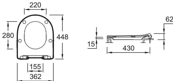
Descriptif CCTP : Abattant thermodur extra-plat à descente progressive. E24889. Collection : ODÉON RIVE GAUCHE. POIDS : 3,6 kg. MATÉRIAU : Thermodur. NORMES ET RÉGLEMENTATIONS : NF. TYPE D'ACCESSOIRE : Abattant extra-plat. BRIDE : Ouverte (traditionnelle). TYPE D'ABATTANT : Extra-plat déclinable à descente progressive. MATÉRIAU DE L'ABATTANT : Thermodur. CHARNIÈRES : Métal. GARANTIE DE L'ABATTANT : 2 ans. CONDITIONNEMENT : 1 colis.
