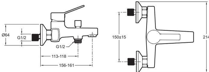
Descriptif CCTP : Mitigeur bain-douche mural. E24160. Collection : E0. TYPE D'INSTALLATION : Mural. TYPE : Mitigeur. DÉBIT (L/MN SOUS 3 BARS) : 12 l/mn / 17 l/mn. RACCORDS : Avec raccords et rosaces murales. MÉCANISME : Cartouche à disques céramique. ENTRAXE (MM) : 150 ± 15. PRODUIT INCLUS : Rosaces. INVERSEUR : verrouillable. GARANTIE MÉCANISME : 5 ans. GARANTIE FINITION : 10 ans.
