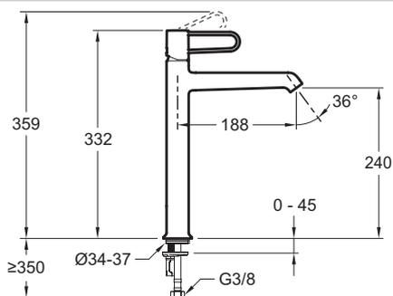
Descriptif CCTP : Mitigeur lavabo haut personnalisable, sans vidage. E21031-00. Collection : ODÉON RIVE GAUCHE. POIDS : 1,7 kg. TYPE D'INSTALLATION : 1 trou. TYPE : Mitigeur. DÉBIT (L/MN SOUS 3 BARS) : 5 l/mn. HAUTEUR TOTALE DU ROBINET (MM) : 332. SAILLIE DU BEC (MM) : 188. RACCORDS : Avec flexibles d'alimentation. MÉCANISME : Cartouche à disques céramique. VIDAGE : Sans vidage. GARANTIE MÉCANISME : 5 ans. GARANTIE FINITION : Chrome 10ans / Blanc et Noir Mat 5ans.
