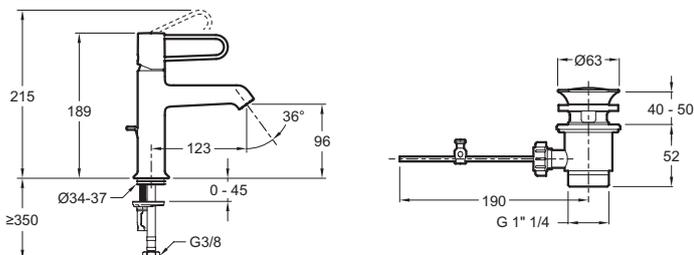
Descriptif CCTP : Mitigeur lavabo avec vidage. E21028-00. Collection : ODÉON RIVE GAUCHE. POIDS : 1,3 kg. TYPE D'INSTALLATION : 1 trou. TYPE : Mitigeur. DÉBIT (L/MN SOUS 3 BARS) : 5 l/mn. HAUTEUR TOTALE DU ROBINET (MM) : 189. SAILLIE DU BEC (MM) : 123. RACCORDS : Avec flexibles d'alimentation. MÉCANISME : Cartouche à disques céramique. VIDAGE : Avec vidage. TYPE D'INSTALLATION : 1 trou. PRODUIT INCLUS : Vidage. GARANTIE MÉCANISME : 5 ans. GARANTIE FINITION : Chrome 10 ans / Couleur 5 ans.
