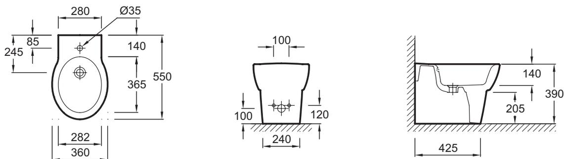
Descriptif CCTP : Bidet au sol caréné. E1705. Collection : OVE. DIMENSIONS : 55 x 36 cm. POIDS : 18 kg. MATÉRIAU : Céramique. TYPE D'INSTALLATION : Au sol. HAUTEUR : Standard. PRODUIT INCLUS : (robinetterie non incluse). Percé 1 trou de robinetterie.
