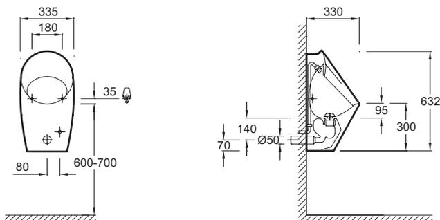
Descriptif CCTP : Urinoir à action siphonique. E1548. Collection : PATIO. DIMENSIONS : 30 x 62 cm. POIDS : 17,5 kg. MATÉRIAU : Céramique. TYPE D'INSTALLATION : Mural. HAUTEUR : Standard. BRIDE : 1. ALIMENTATION : Encastrée. Alimentation encastrée, évacuation encastrée, livré avec équipement complet (fixation E4598, effet d'eau E74203, flexible E74187, bonde à grille E78166, siphon S.H. E6333).
