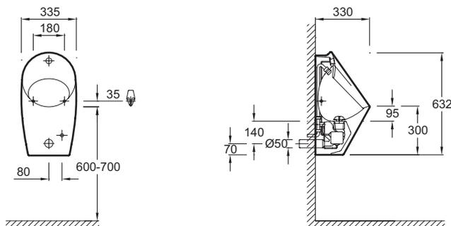
Descriptif CCTP : Urinoir à action siphonique. E1547. Collection : PATIO. DIMENSIONS : 30 x 62 cm. POIDS : 19 kg. MATÉRIAU : Céramique. TYPE D'INSTALLATION : Mural. HAUTEUR : Standard. BRIDE : 1. ALIMENTATION : Encastrée. Urinoir à action siphonique avec commande électronique.
