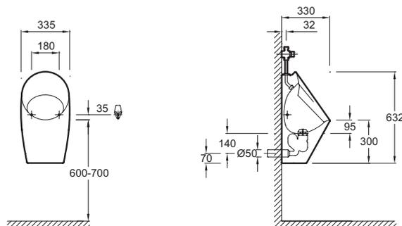
Descriptif CCTP : Urinoir à action siphonique. E1546. Collection : PATIO. DIMENSIONS : 30 x 62 cm. POIDS : 17,5 kg. MATÉRIAU : Céramique. TYPE D'INSTALLATION : Mural. HAUTEUR : Standard. BRIDE : 1. ALIMENTATION : Par-dessus. Alimentation apparente, évacuation encastrée, livré avec équipement complet (fixation E4598, effet d'eau E74203, flexible E74187, bonde à grille E78166, siphon S.H. E6333).
