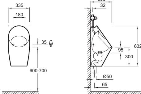
Descriptif CCTP : Urinoir à action siphonique. E1545. Collection : PATIO. DIMENSIONS : 30 x 62 cm. POIDS : 17,5 kg. MATÉRIAU : Céramique. TYPE D'INSTALLATION : Mural. HAUTEUR : Standard. BRIDE : 1. ALIMENTATION : Par-dessus. Alimentation apparente, évacuation apparente, livré avec équipement complet.
