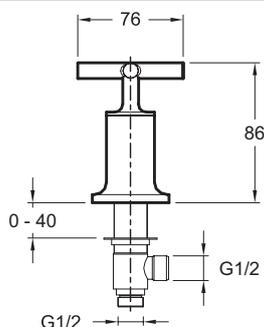
Descriptif CCTP : Kit 2 poignées/têtes pour mélangeur bain. E144293. Collection : PURIST. POIDS : 2,7 kg. TYPE D'INSTALLATION : Mural. NORMES ET RÉGLEMENTATIONS : ACS : 15 ACC LY 081. DÉBIT (L/MN SOUS 3 BARS) : 43 l/mn. TYPE D'INSTALLATION : 2 trous. TYPE D'ACCESSOIRE : Poignée.
