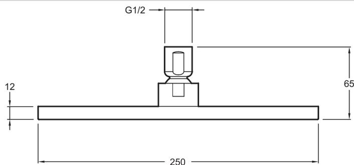
Descriptif CCTP : Douche de tête carrée 250 x 250 mm. E13696. Collection : KATALYST. DIMENSIONS : 25 x 25 cm. POIDS : 3 kg. TYPE D'ACCESSOIRE : DOUCHE DE TETE. MITIGEUR : MECANIQUE. TYPOLOGIE DE ROBINETTERIE DE DOUCHE : Mécanique. TYPE DE SYSTÈME DE ROBINETTERIE DE DOUCHE : AVEC SYSTÈME MODULO. Rotule orientable et picots anti-calcaire. Avec technologie Katalyst (ajout de 2 litres d'air/minute).
