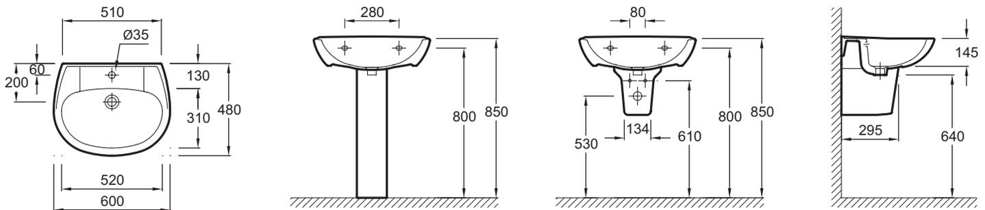
Descriptif CCTP : Lavabo 60 cm. E1286. Collection : BRIVE. DIMENSIONS : 60 x 48 cm. POIDS : 14,2 kg. MATÉRIAU : Céramique. TYPE D'INSTALLATION : Autoportant. FIXATIONS : 3 types de fixations possibles : Goujons, consoles ou crochets. PERCEMENT ROBINETTERIE : Percé 1 trou pour robinetterie. CONFIGURATION : STANDARD. TROP-PLEIN : Avec trou de trop plein. PRODUIT INCLUS : (robinetterie non incluse). OPTIONS : Colonne, cache-siphon.
