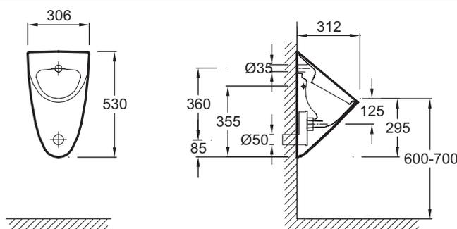
Descriptif CCTP : Urinoir à action siphonique. E1147. Collection : ODÉON UP. DIMENSIONS : 31,20 x 30,60 cm. POIDS : 12,3 kg. MATÉRIAU : Céramique. TYPE D'INSTALLATION : Mural. BRIDE : 1. ALIMENTATION : Encastrée. PRODUIT INCLUS : Kit de fixation latéral. CONDITIONNEMENT : 1 colis.
