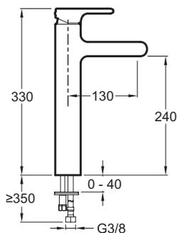
Descriptif CCTP : Mitigeur lavabo - modèle haut - avec flexibles d'alimentation. E10861. Collection : SINGULIER. POIDS : 3 kg. TYPE D'INSTALLATION : 1 trou. TYPE : Mitigeur. DÉBIT (L/MN SOUS 3 BARS) : 7 l/mn. RACCORDS : Avec flexibles d'alimentation. MÉCANISME : Cartouche à disques céramique. VIDAGE : Avec vidage. TYPE D'INSTALLATION : 1 trou. GARANTIE MÉCANISME : 5 ans.
