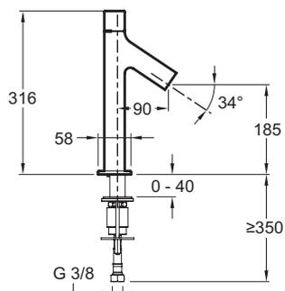
Descriptif CCTP : Mitigeur lavabo - modèle haut - avec flexibles d'alimentation. E10379. Collection : OBLO. POIDS : 2,9 kg. TYPE : Mitigeur. DÉBIT (L/MN SOUS 3 BARS) : 8 l/mn. RACCORDS : Avec flexibles d'alimentation. MÉCANISME : Cartouche à disques céramique. TYPE D'INSTALLATION : 1 trou. GARANTIE MÉCANISME : 5 ans.
