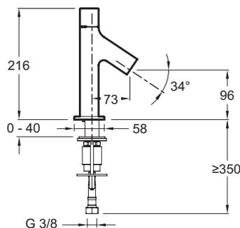
Descriptif CCTP : Mitigeur lavabo avec flexibles d'alimentation. E10378. Collection : OBLO. POIDS : 2,1 kg. TYPE : Mitigeur. DÉBIT (L/MN SOUS 3 BARS) : 8 l/mn. RACCORDS : Avec flexibles d'alimentation. MÉCANISME : Cartouche séquentielle. TYPE D'INSTALLATION : 1 trou. GARANTIE MÉCANISME : 5 ans. Cartouche séquentielle. Aérateur anti-calcaire intégré.
