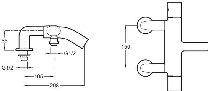
Descriptif CCTP : Mélangeur bain-douche sur gorge. E10107. Collection : OBL0. POIDS : 4,2 kg. NORMES ET RÉGLEMENTATIONS : ACS : 15 ACC LY 081. TYPE : Mélangeur. RACCORDS : Avec raccords colonnettes. MÉCANISME : Têtes à disques céramique. ENTRAXE (MM) : 150. INVERSEUR : Automatique discret autour de la sortie du flexible de douche. GARANTIE MÉCANISME : 5 ans. Inverseur automatique discret (autour de la sortie du flexible de douche). Clapets anti-retour sur sortie douche.
