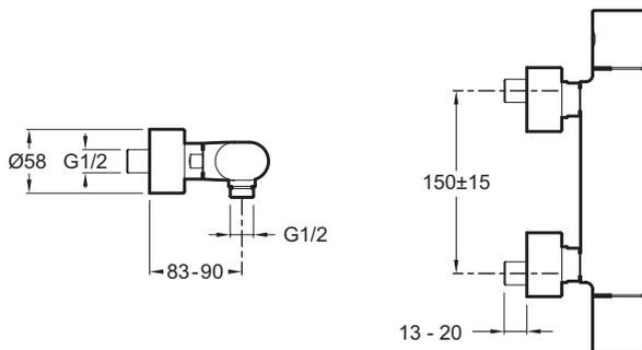
Descriptif CCTP : Mitigeur thermostatique douche mural. E10091. Collection : OBLO. POIDS : 3,1 kg. TYPE D'INSTALLATION : Mural. TYPE : Mitigeur. DÉBIT (L/MN SOUS 3 BARS) : 13 l/mn. RACCORDS : Avec raccords et rosaces murales. MÉCANISME : Cartouche thermostatique. ENTRAXE (MM) : 150 ± 15. MITIGEUR DE BAIN : MITIGEUR THERMOSTATIQUE. TYPE D'INSTALLATION : 2 trous. MITIGEUR DE DOUCHE : Thermostatique. BUTÉE DE SÉCURITÉ : 40°C. CORPS TIÈDE : Oui. GARANTIE MÉCANISME : 5 ans.
