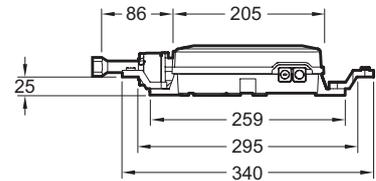
Descriptif CCTP : Unité thermostatique. 528D-K. Collection : DTV PROMPT. DIMENSIONS : 34 x 32 x 6,80 cm. POIDS : 3 kg. TYPE D'INSTALLATION : Encastré. TYPE DE SYSTÈME DE ROBINETTERIE DE BAIN : Avec Système DTV. 2 alimentations G1/2, 2 sorties G1/2. A raccorder au secteur.
