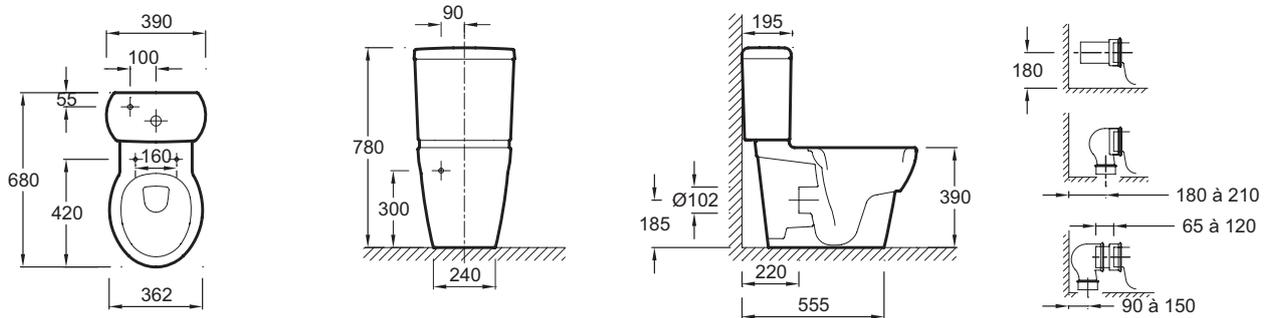
Descriptif CCTP : Cuvette sortie vario. 19974W. Collection : OVE. DIMENSIONS : 68 x 36,20 cm. POIDS : 30,1 kg. MATÉRIAU : Céramique. TYPE D'INSTALLATION : Au sol. CONSOMMATION D'EAU : Standard 3/6 L. HAUTEUR : Standard. BRIDE : 1. TYPE D'ABATTANT : A descente progressive. LIVRÉ AVEC : Abattant thermodur à descente progressive E70005, charnières métal.
