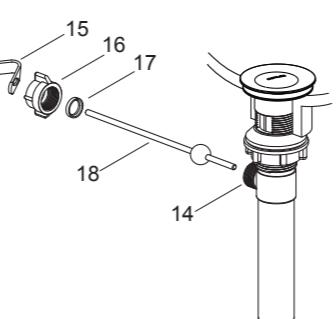
确保球杆(18)指向脸盆后方，用扳手拧紧排水本体上的锁紧螺母(13)。
