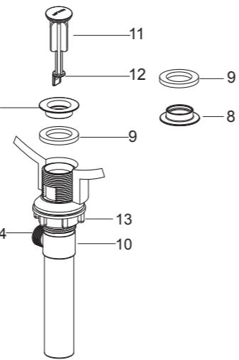
**注意：**如果需要，可直接在法兰盘(8)底面沿周围涂一圈密封油灰，或其他密封剂，而不使用垫片(9)。
