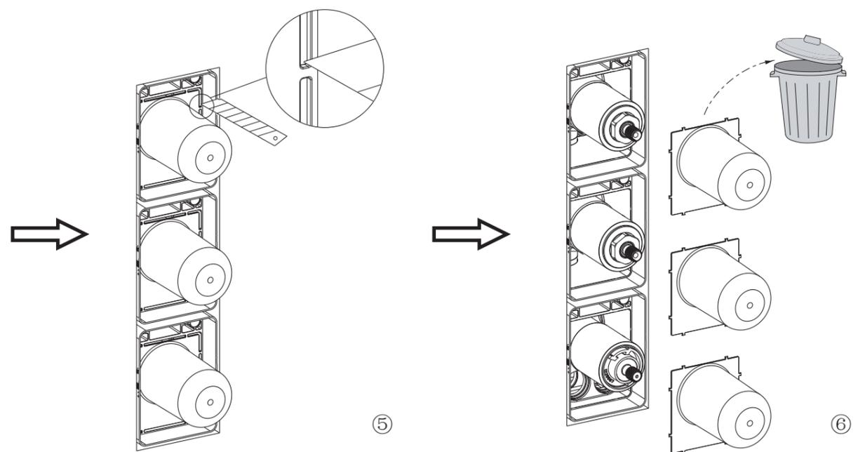
用美工刀刻掉阀芯保护套的连接。
