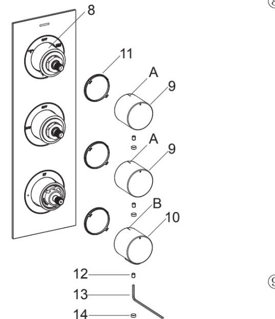
将把手组件(9,10)带摩擦环(11)安装到阀芯上。确保把手(10)上的标示A与面板上的数字“37”对齐，把手(9)上的标示B与面板上的“OFF”对齐。
