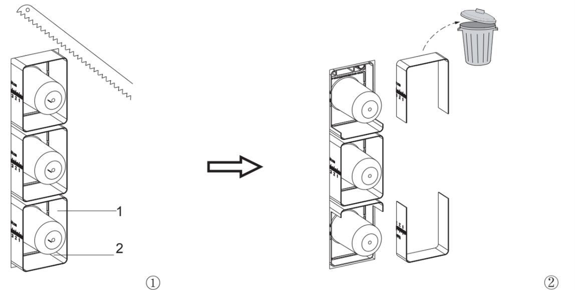
从上下两边向中间锯，锯掉保护套外圈(1)凸出墙面的部分，注意不要锯到阀芯保护套(2)。
