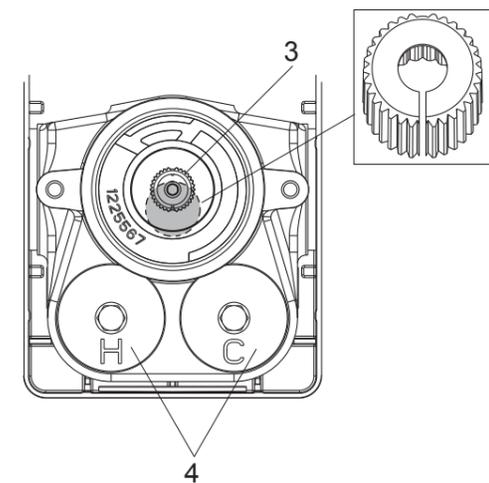
**注意：**安装过程中不要转动阀轴。确保温控阀芯阀套(3)上的豁口垂直向下。
