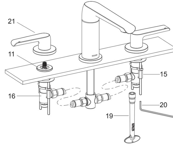
用3mm的六角扳手(20)锁紧螺杆以固定阀体。用扳手(19)锁紧螺母(15)。
