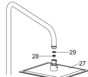
安装头顶花洒前, 可根据需要安装限流器(28)。先取出垫片(29), 按图示方向放入限流器, 再装回垫片。
