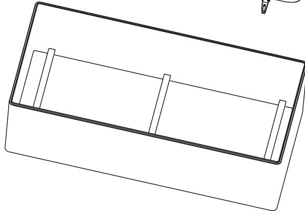
5. Level the bath and adjust apron gap to about 15mm. 5. 检查浴缸水平，调整裙边间隙均匀保持15毫米。
