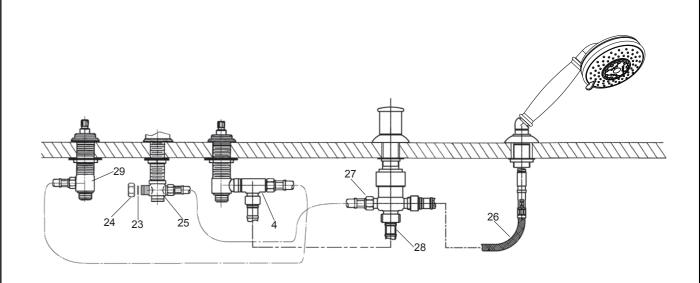
把垫片(23)放入螺母(24),并将其旋到所选配浴缸出水口的T型接头(25)的任意端口上锁紧。
