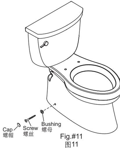
小心的将螺丝旋入支架中直到座便器完全固定。左右交替旋紧以免座便器偏离中心。安装螺帽。
