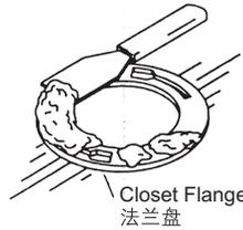
用涂油灰刀拆除地上的旧密封垫圈及座便器法兰盘，拆除及扔掉旧的T型螺栓。
