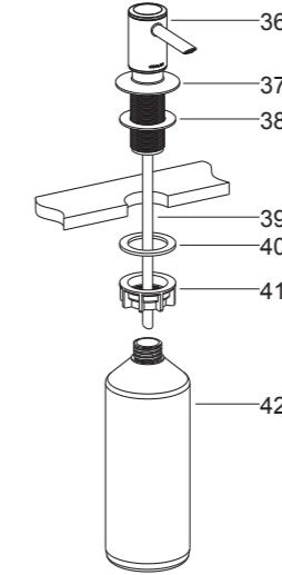
从脸盆下方将垫片(40)和锁紧螺母固定到乳液器组件。
