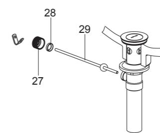
将固定螺母(27)取下，把塑料垫圈(28)及固定螺母装在球杆(29)上，再把球杆组件插入排水杆的洞口中并穿过止水塞，拧紧固定螺母。
