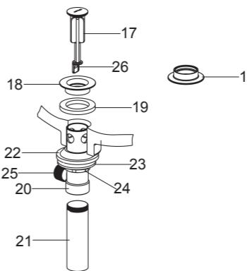
**注意：**如果需要，可直接在排水器法兰盘(18)底面沿周围涂一圈密封油灰，而不使用垫片(19)。
