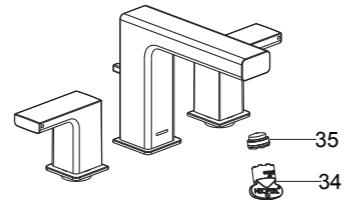
用工具(34)将起泡器(35)拆下，打开龙头的冷热水，让水流出约一分钟以清除杂质。冲洗起泡器，关闭龙头，重新装回起泡器。
