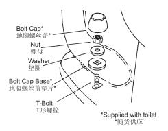
Fig.#6 图6 将地脚螺丝盖垫片、垫圈和螺母套在外露的T型螺栓上,用手上紧所有螺母,再用板钳额外上紧半圈。
