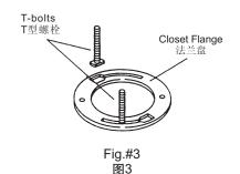
安装两枚直径8mm的新T型螺栓在法兰盘上。
