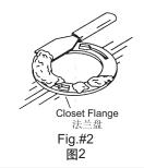
用涂油灰刀拆除地上的旧密封垫圈及座 便器法兰盘,拆除及扔掉旧的T型螺栓。
