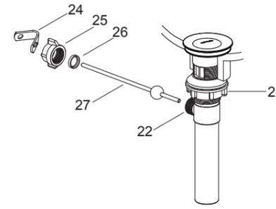
将固定螺母(25)取下,把塑料垫圈(26)及固定螺母装在球杆(27)上,把球杆组件插入排水杆洞口中并穿过止水塞,拧紧固定螺母。
