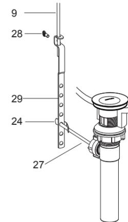
把手捻螺丝(28)装到联杆(29)上。用“V”形夹(24)将联杆连接到球杆(27)上。
