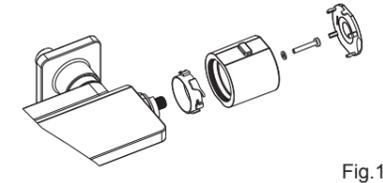
将螺母和塑料套卸下。小心地卸下温控阀。用热醋进行清洗。
