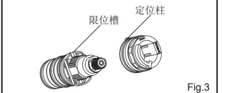
将塑料套的定位柱与龙头本体内部凹槽对齐，装入温控阀并锁紧螺母。
