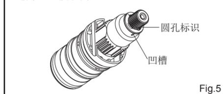
不要转动温控阀轴，将轴套上的凸起对准本体上的凹槽装入。安装温控把手，使温控把手上带有按钮的一面水平朝上并与本体对齐。确保垫片套在螺钉上，锁紧螺钉，安装把手上盖。
