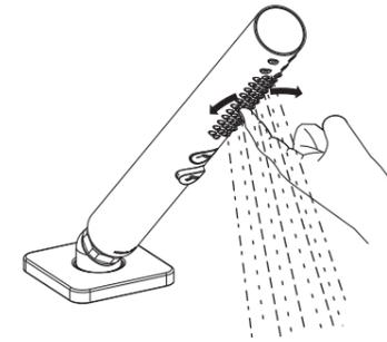
喷孔杂质或结垢会导致水流变形，流量变小。打开水源，用力按压或摩擦橡胶喷孔，去除杂质或水垢。
