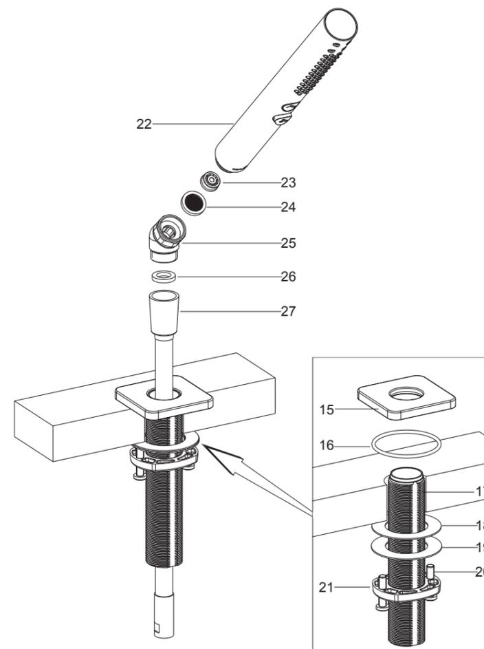
将螺钉(20)旋入安装环(21)螺钉孔。依次将安装环、钢垫(19)和垫片(18)装到牙管(17)上。如图所示, 将牙管从浴缸下方插入安装孔。
