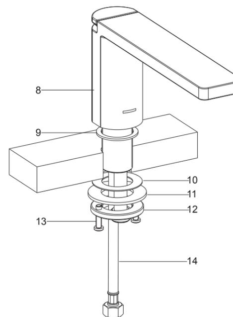
将垫片(9)装在出水口组件(8)底部, 从浴缸上方将出水口组件带软管(14)插入安装孔中。
