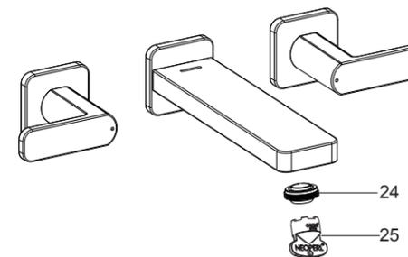
检查并确保所有的衔接处都已拧紧。确保手柄处于关闭位置。打开排水系统和主要供水源，检查并修理有漏水的接口。
