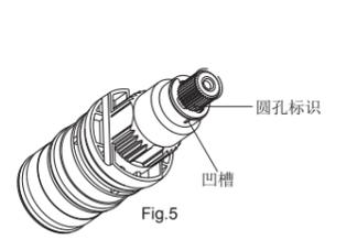
**注意：**确保拆卸安装过程中，不要转动温控阀轴。如不小心转动了阀轴，要调整阀轴使外齿上的圆孔标识与相邻的塑套上的凹槽对齐(Fig.5)，或者按前述方法调整。
