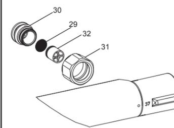
滤网垫片(29)可起到保护龙头的作用，但长时间使用后，水垢或杂质可能会堵塞滤网，降低水流量。如果有类似情况发生，卸下龙头，用六角扳手(12mm)将底座(30)，顺时针)拧下，取下螺母(31)、滤网垫片(29)以及单向阀(32)。用热醋清洗滤网。然后按照图示装回。(注意：单向阀必须按原方向装回)。
