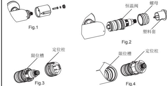
如果供水的水质较硬或长时间使用，水垢或杂质会阻塞温控阀上的滤网，流量会降低。需要清理请按照下列步骤进行：关闭供水系统，使流量阀处于打开位置后进行温控阀的拆卸作业。温控阀是较敏感的配件，所以要十分小心。
