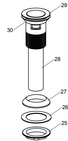
**注意：**如果需要，可直接在排水器盘片(29)底面沿周围涂一圈密封油灰或其他密封剂，而不使用橡胶垫片(30)。
