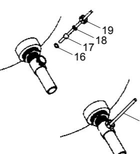
确定球动杆指向洗面盆后方，再次拧紧排水本体的锁紧螺母(13)，去除多余油灰。
