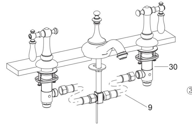
将软管(9)与阀体出水口(30)相连接。
