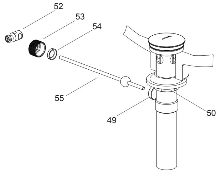
将接头(52)及固定螺母(53)取下，把塑料垫圈(54)及固定螺母装在球杆(55)上，把球杆组件插入排水杆的洞口中并穿过止水塞，拧紧固定螺母。
