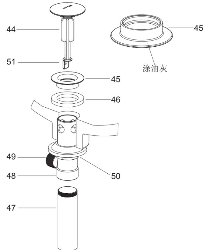
将止水塞(44)、法兰盘(45)、垫片(46)及尾管(47)从排水本体(48)上取下。在尾管螺纹处须缠绕足以密封的密封胶带或涂合适的密封胶，装回到排水本体上。把排水本体组件从脸盆下方插到脸盆中，排水杆口(49)朝后方。把法兰盘带垫片旋入到排水本体中，从下方用手拧紧锁紧螺母(50)。
