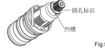
安装温控把手(不要转动温控阀轴)，使参考标识同数字37对齐，拧紧螺钉。安装把手上盖。
