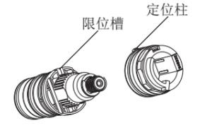
然后将塑料套的定位柱与龙头本体内凹槽对齐，装入温控阀并锁紧螺母。
