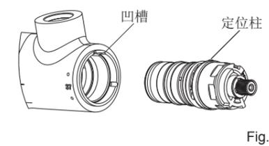
**注意：**确保拆卸、安装过程中不要转动温控阀轴。如不小心转动了阀轴，要调整阀轴使外齿上的圆孔标识与相邻的塑料套上的凹槽对齐，或者按前述方法进行调整。
