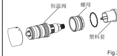
清洗后将塑料套和螺母(限位组件)装到温控阀上，使塑料套的定位柱嵌入温控阀的限位槽内。
