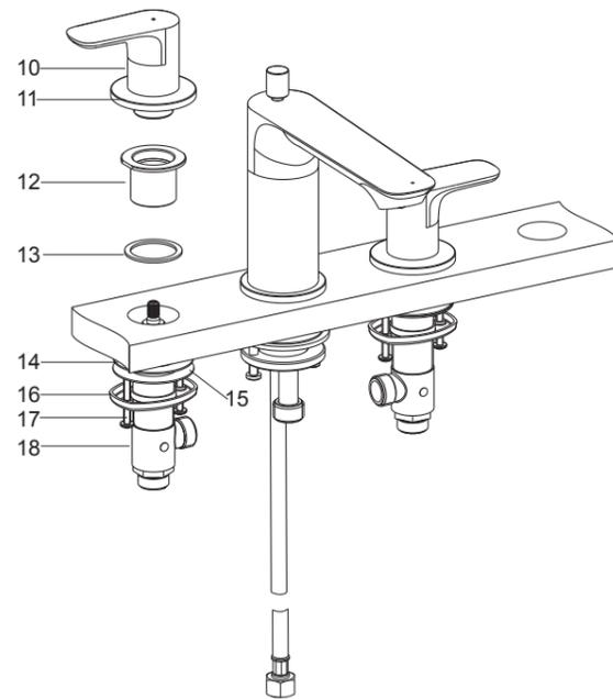
将把手组件(10)、螺母(12)与垫片(13)从阀体组件(18)上取下。确保垫片(14)、钢垫(15)和安装环(16)依次装在阀体上。
