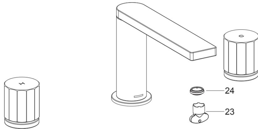
检查并确保所有的衔接处都已拧紧。确保手柄处于关闭位置。
