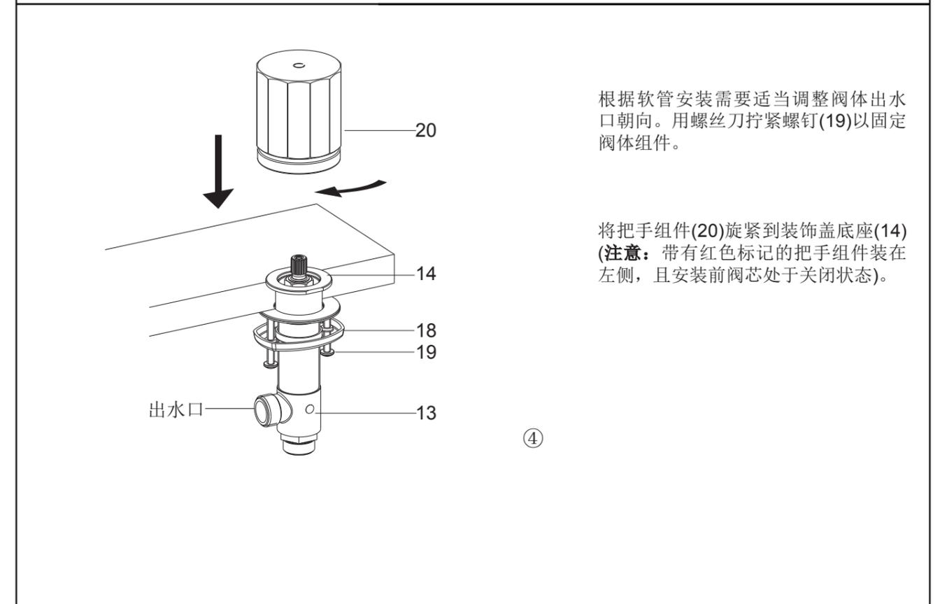
根据软管安装需要适当调整阀体出水口朝向。用螺丝刀拧紧螺钉(19)以固定阀体组件。
