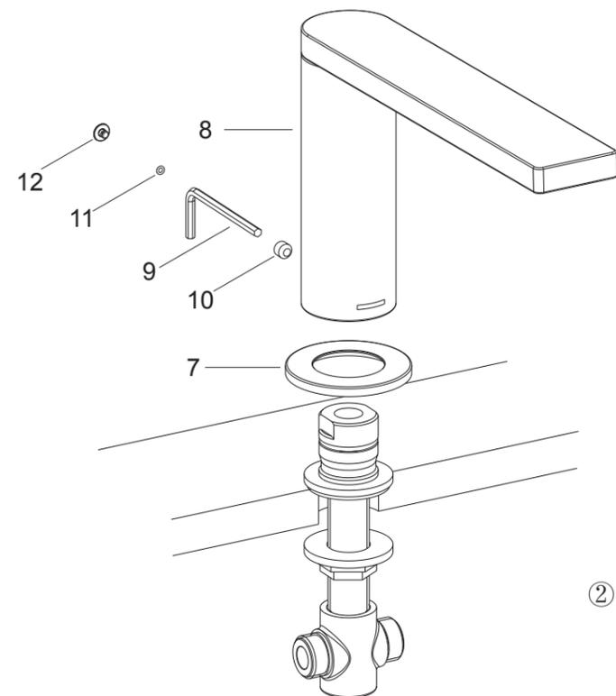
取下出水口背部的塞扣(12)和O型圈(11)，用扳手(9)旋松螺钉(10)。
