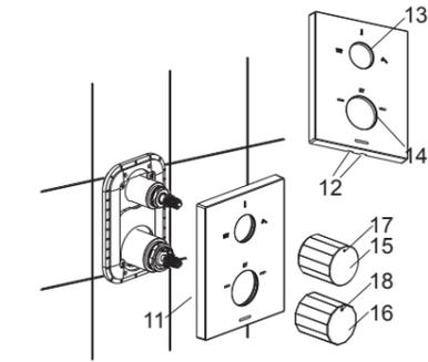
将面板(11)套在阀体上，使开槽(12)向下(**注意：**不要弄丢孔内O型圈(13, 14))。将其后推，直至与墙面接触。将把手(15, 16)装到阀轴上，把手上的圆点标识(17, 18)垂直向上。
