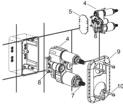
取下阀体组件(4)底部保护板(5)，**注意：**不要弄丢底部O型圈(6)，安装过程中不要转动阀轴(7)。阀体底部各孔对准安装盒底部各孔，将阀体装入安装盒，锁紧螺钉(8)。
