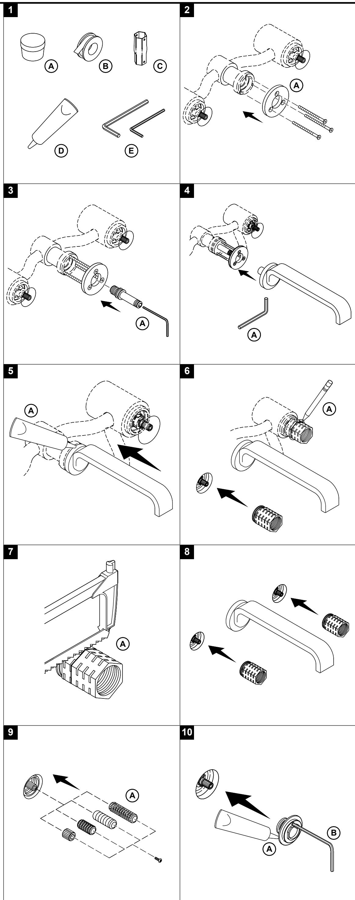
poignée sans dépasser de l'adaptateur de la poignée. Fixer la vis d'arrêt en place avec une clé hexagonale de 5/64 po (non fournie).
