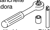
Socket Wrench with 11 mm or 7/16" Socket and Extension Clé à douille avec douille et rallonge de 11 mm ou de 7/16" Llave de dados con extensión y dado de 11 mm o 7/16"
