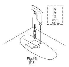
用**10mm**的钻头在地面上钻孔,然后插入螺栓套管。
