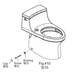
小心的将螺丝旋入支架中直到座便器完 全固定。左右交替旋紧以免座便器偏离 中心。安装螺帽。
