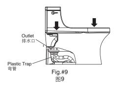
小心对准并将座便器向下放置。同时将座便器边缘向下压,以使排水口插入弯管中。为了要达到最佳的效果,请在安装时确定座便器是否水平。
