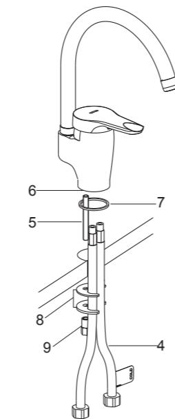
从厨盆下方把托架(8)和螺母(9)套入固定螺栓(5)。调整水龙头的位置，使出水口位于水龙头的后方，并拧紧螺母以便把水龙头固定在厨盆上。
